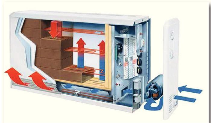
Figure 2 : Accumulateur thermique à air forcé.
