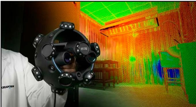
Figure 1 : Utilisation du scanner 3D pour la numérisation d'une salle de travail.
