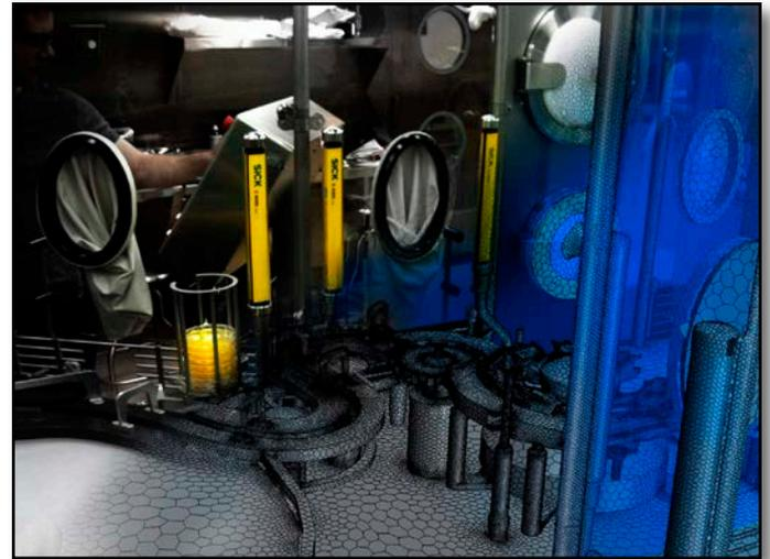
Figure 2 : Maillage surfacique avec cellules polyédriques dans une enceinte de procédé pharmaceutique.
