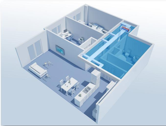
Diffusion d'air par conduits minimalistes : surface recouverte de faux plafonds plus réduite (en bleu)
